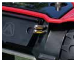
Capteur de pluie pouvant être désactivé Regensensor, der deaktiviert werden kann
